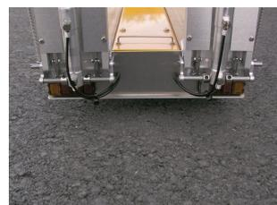
Mit unserem Rampen – Umbausatz kann der WEDICO Tieflader mit hydraulisch betätigten Rampen ausgerüstet werden.
