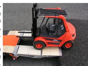
Mit unserem Rampen – Umbausatz kann der CARSON Goldhofer - Tieflader mit hydraulisch betätigten Rampen ausgerüstet werden. Die benötigten Hydraulik-Komponenten finden Platz in der Mitte des Unterbodens unter dem Tieflader und belegen somit keinen zusätzlichen Platz (z.B. in der Pritsche).
