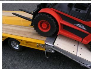
Auf Grund des Vierregelungs-Mechanismus unserer Rampen bleiben diese bis zu einer gewissen Winkelstellung befahrbar, ohne in der Mitte einzuklappen.
